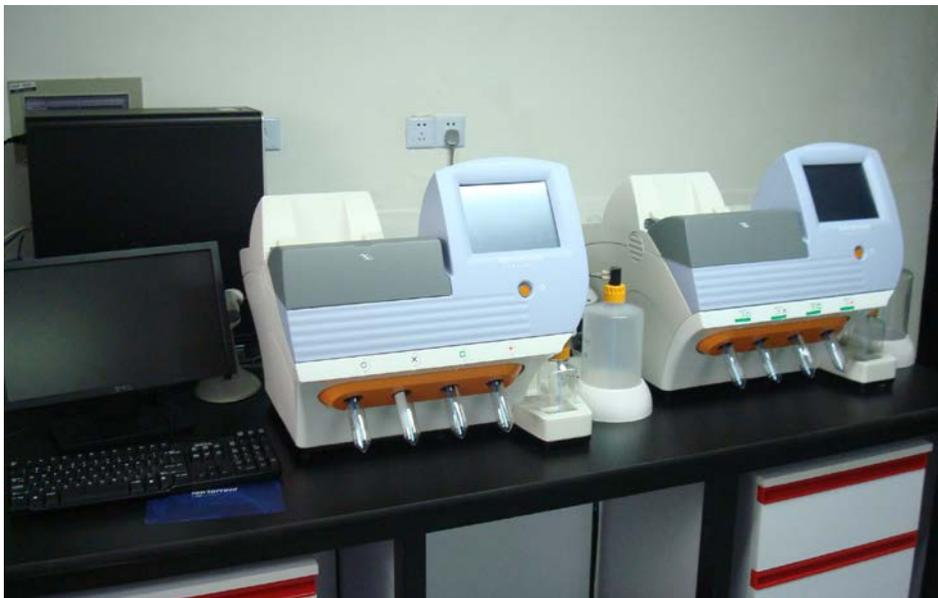
图 15. 个人化操作基因组测序仪
